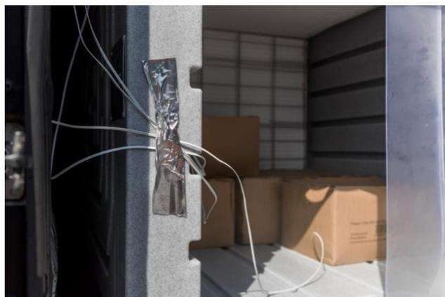
*Figura 2. Sensori di temperatura all'interno del Coldtainer*
