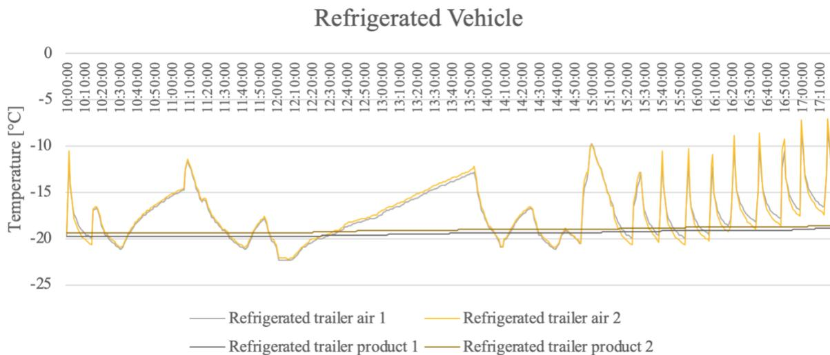
Figura 11. Misure dei sensori delle temperature all'interno del veicolo refrigerato e del prodotto congelato (Sistema di refrigerazione tradizionale)
