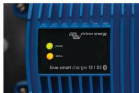
☐ quando il LED STATUS (giallo) lampeggia lentamente il caricabatterie è passato alla fase di assorbimento (la fase di bulk/accumulo è completata); la batteria sarà carica circa al 70%.
