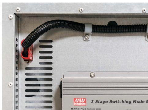
La batteria interna dovrà essere ricaricata dopo l'uso, con il caricabatteria compreso nella fornitura, alimentato dalla rete di rete AC.
